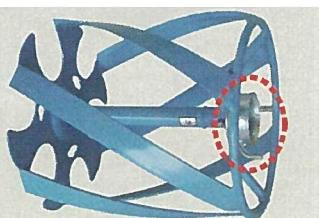
ブルースパイラルは、車軸の「受け」部分に『からまんカラー』を装備。回転する車軸をカバーしながら、それ自身は回転しない構造で、丈の高い、長い草であっても、車軸部への巻き付きを抑えます。
