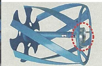
ブルースパイラルは、車軸の「受け」部分に『からまんカラー』を装備。回転する車軸をカバーしながら、それ自体は回転しない構造で、丈の高い、長い草であっても、車軸部への巻き付きを抑えます。
