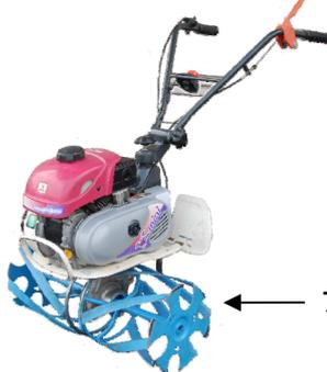
※ブルースパイラルを本機へセットする際は本機に標準でセットされているロータを片側ずつ取りはずしてセットしてください。
